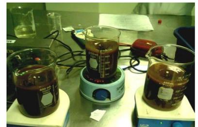
Prueba de jarras para determinación de uso de coagulante
